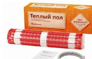
Теплый пол Warmstad WSM - выпускается в виде нагревательных матов длиной от 1,3 до 29 метров. В качестве греющего элемента выступает двухжильный кабель резистивного типа. Высота нагревательного мата не превышает 5 мм. Устанавливаются в тонкий слой плиточного клея или самовыравнивающейся смеси.
